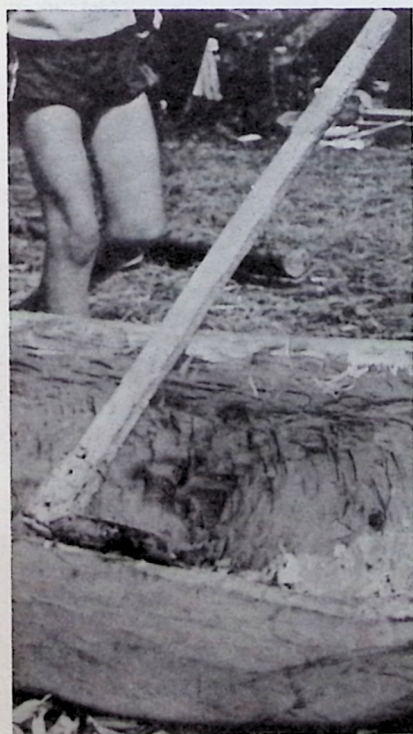
Her ses det vigtigste redskab i udhulningen, den runde skarøkse, som skal specialmedes. Udhulningen af stammen er endnu ikke tilendebragt
