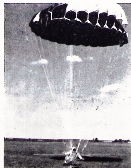
Landing med styrbar skærm. Man ser landingskrydset og styrelinerne, som går fra hopperens hænder op til styreåbningerne.
