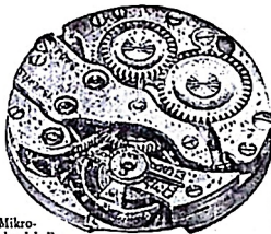
Mikro- skopisk Fo- tografi af et Ur. Læg Mær- ke til Støv og Glassplinter, der skyldes et knust Urglas.
